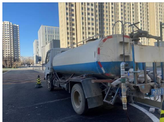
洒水除尘 (2023年2月)
